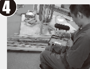
刃を入れるのは竹の節の部分だけ。それ以外のところは、竹をしごくことで勝手に割れていき、バラけていく。もちろん、しごき方には熟練のコツが要る。
