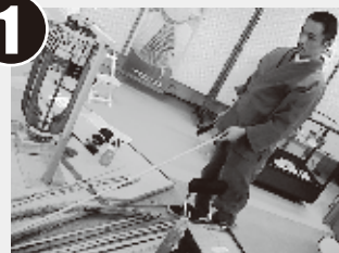
竹を割いて竹ひごをつくる。縦に半分に割った竹をさらに半分に割いて、それをまた割いて、物差しくらいの幅になるまで割く。
