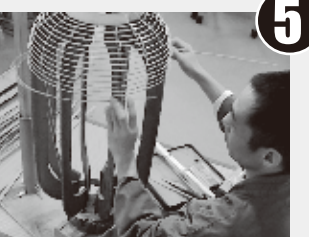
こうして骨ができたら、張り型に骨を沿わせていく。張り型の周りにクルッと骨を沿わせて、骨の両端を、のりを塗った和紙でクルクルッと接着して固定し、竹ひごでできた骨で円をたくさんつくる。
